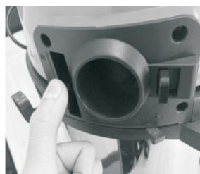
Kun haluat käyttää puhallustoimintoa, kytke letkun liitin puhallusaukkoon kuvassa näytetyllä tavalla. Siirrä lukitsinta oikealle, kiinnitä letkun liitin puhallusaukkoon. Päästä lukitsin niin, se lukittuu tiiviisti. Avaa puhallus siirtämällä säädintä vasemmalle, ja sulje se oikealle siirtämällä.
