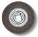
TERÄSHARJA Ø 250 mm x 60 mm, erinomainen teräslangan lujuus erityisen taloudelliseen käyttöön, kiinnitysporaus Ø 51 mm. Teräslangan paksuus 0,2 mm ohutseinäisille putkille ja profiileille. Teräslangan paksuus 0,35 mm yleiskäyttöä varten. Teräslangan paksuus 0,5 mm paksuseinäisille putkille ja profiileille suurta jäysteenpoistotehoa varten. Teräsmalli
