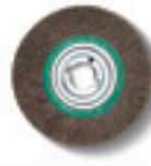
TERÄSHARJA Ø 250 mm x 60 mm, erinomainen teräslangan lujuus erityisen taloudelliseen käyttöön, kiinnitysporaus Ø 51 mm. Teräslangan paksuus 0,2 mm ohutseinäisille putkille ja profiileille. Teräslangan paksuus 0,35 mm yleiskäyttöä varten. Teräslangan paksuus 0,5 mm paksuseinäisille putkille ja profiileille suurta jäysteenpoistotehoa varten. Jaloteräsmalli
